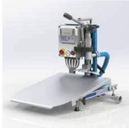
Diese leicht zu bedienende, manuelle Abfüllmaschine ist perfekt für kleine Produktionen von SAROBAGinBOX Beuteln bis 20 Liter und Stehbeutel bis 3 Liter. Das Abfüllen wird durch Schwerkraft ermöglicht.
