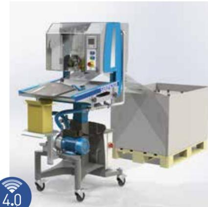
Flexible, halbautomatische Füllmaschine, welche Einzelbeutel (Single) wie auch Kettenbeutel (Web) verarbeiten kann. Sie ist für das Abfüllen von SAROBAGinBOX Beuteln bis 20 Liter und Stehbeutel bis 5 Liter ausgelegt (Stehbeutel nur im Single-Modus möglich). Sie eignet sich für sämtliche Arten von flüssigen und halbflüssigen Food- oder Non-Food-Produkten.
