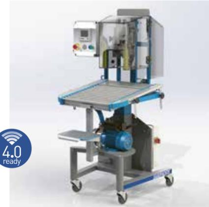
Die halbautomatische Abfüllmaschine SAROPACKER PROFIFILL ist für die Abfüllung von SAROBAGinBOX Beuteln bis 20 Liter und Stehbeutel bis 5 Liter konzipiert. Sie kann für alle Arten von Flüssigkeiten und Halbflüssigkeiten sowohl im Lebensmittel- als auch im Non-Food-Bereich verwendet werden.
